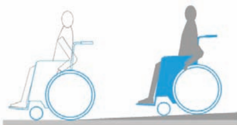
Final de la rampa nivelada a piso
